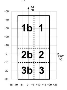
// AT – температура воздуха // LWT – температура исходящей жидкости (вода или антифриз)
